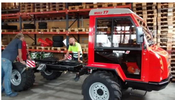
Obr. 17: Malé terénne nákladné vozidlo značky Reform určené pre samosprávy v procese montáže nadstavby na podvozok.
