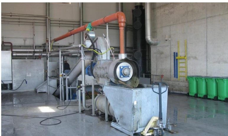
Obr. 26: Pred vstupom do anaeróbneho fermentora sa reštauračný bioodpad musí hygienizovať zahriatím na 70 °C počas 1 hod. Pred tým sa ešte musí pomlieť. Mletie prebieha v tomto zariadení.
